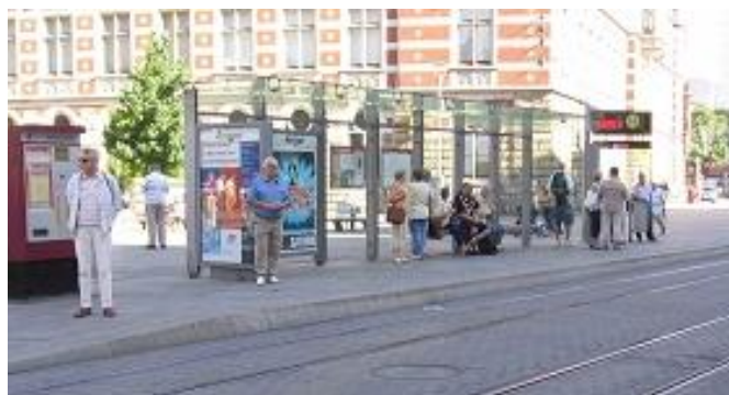
Ideale Anordnung einer Bushaltestelle hier als Kaplösung – rechts: Beispiel Erfurt, Häßlerstr. mit Kaseler Sonderbord (18 cm) zur Gewährleistung des barrierefreien Einstiegs
