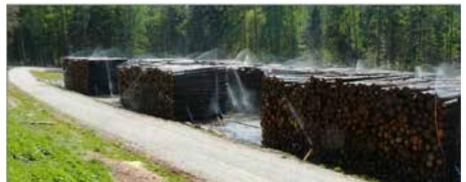
*Kreislaufsystemare Bewässerung von Rundholzabschnitten im Probebetrieb (Foto: Stuhlmann 2010)*
