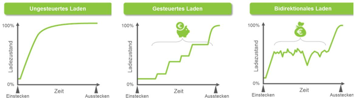
Abbildung 67: Verschiedene Ladetechniken im Vergleich (Quelle: [www.mobilityhouse.com](http://www.mobilityhouse.com))
