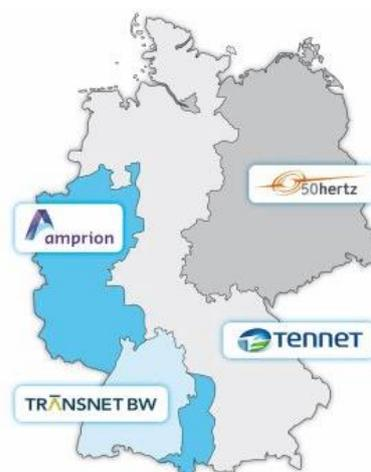
Abbildung 74: Regelzonen der Übertragungsnetzbetreiber (vgl. Speckamp 2016)
