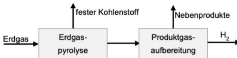
**Abbildung 2-11: Schematische Darstellung Erdgas-Pyrolyse [1]**
