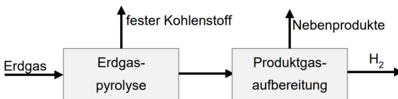
Abbildung 11: Schematische Darstellung der Erdgaspyrolyse [48]
