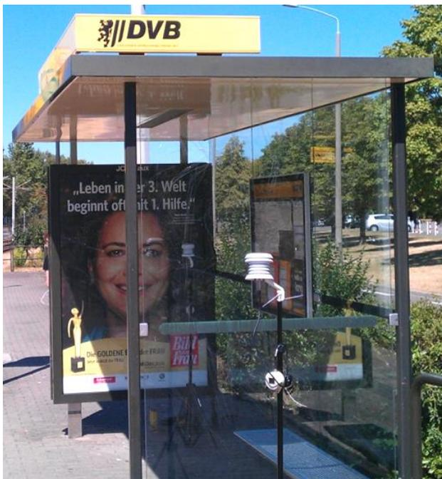
*Abbildung 2: Dreiseitig umschlossener Fahrgastunterstand mit Glaswänden und Metaldach am Dahlienweg (sowie zwei Messgeräte inner- und außerhalb des Unterstands; © Umweltamt der Landeshauptstadt Dresden)*
