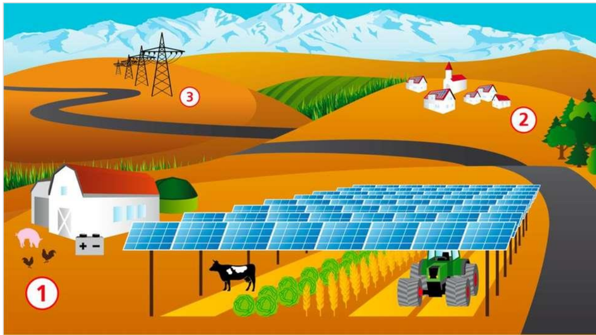
Abbildung 42: Nutzungsmöglichkeit des Stroms einer APV-Anlage: (1) Technischer Eigenverbrauch (mit Speicher), (2) Direktvermarktung an naheliegende Wohnsiedlung, (3) Energieeinspeisung ins Stromnetz (Trommsdorff et al., 2020).
