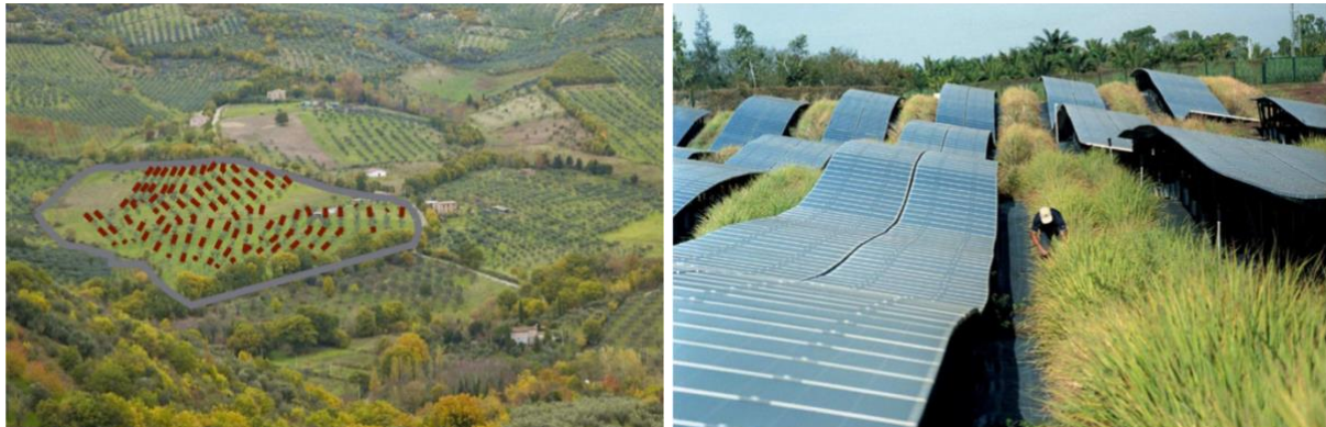
Abbildung 39: Integrativer Gestaltungsansatz von APV-Anlagen. (a) Mosaik-Anordnung angepasst an natürliches Landschaftsbild, (b) Bodennahe Anlagen, die der natürlichen Linienstruktur der Landschaft folgen (Scognamiglio, 2015).
