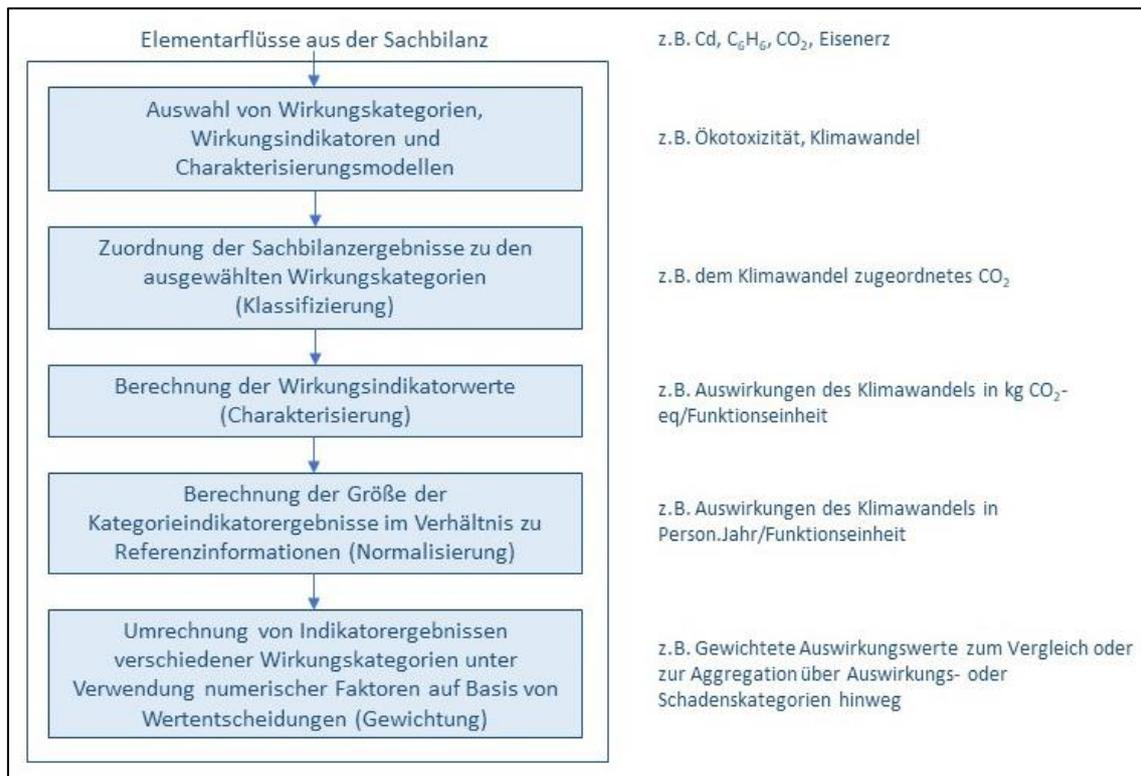
Abbildung 14: Schema und Beispiele zur Durchführung einer Wirkungsabschätzung nach Hauschild und Huijbregts (2015, S. 5)
