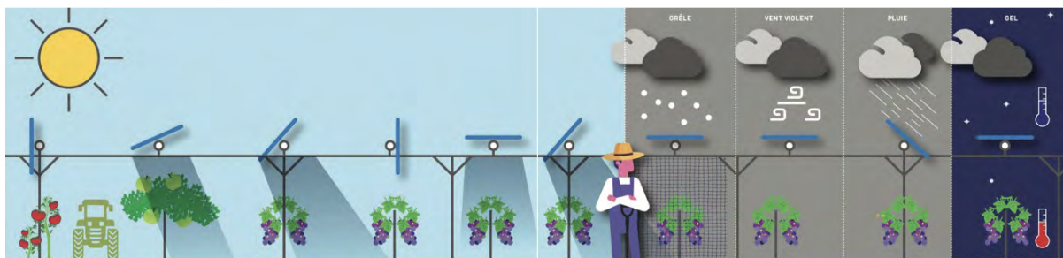
Abbildung 35: Mögliche Schutzwirkungen der Kulturen durch verschiedene Ausrichtungswinkel bei (Anti-)Tracking-Systemen (Vandest und Hemetsberger 2021).
