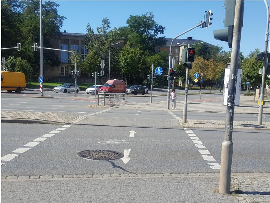
Abbildung 41: Führung in beiden Richtungen am Knotenpunkt zur Verminderung von Wartezeiten (hier: Fritz-Förster-Platz, Dresden)
