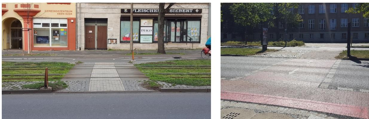
Abbildung 40: Einfache Querungsmöglichkeiten bei großen Verkehrsadern (Bild links: mit Straßenbahntrasse (Magdeburger Allee, Erfurt), Bild rechts: vierspurig mit Grünstreifen in Mittellage (Zellescher Weg, Dresden))
