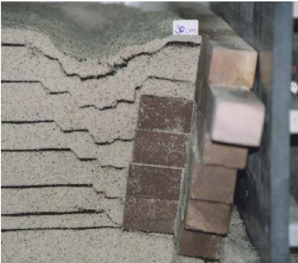
Mit den Modellversuchen werden Vorgänge innerhalb und außerhalb eines Bauwerks sichtbar und verständlich. Die Versuchsdurchführung erfolgt unter permanenter Messung von Kräften und Verschiebungen bis hin zum Versagen. Die jeweils untersuchte Konstruktion kann ohne Substanzverlust zum Grenzzustand der Tragfähigkeit gebracht werden. Eine Aussage über das Sicherheitsniveau und dessen Reserven wird möglich.
