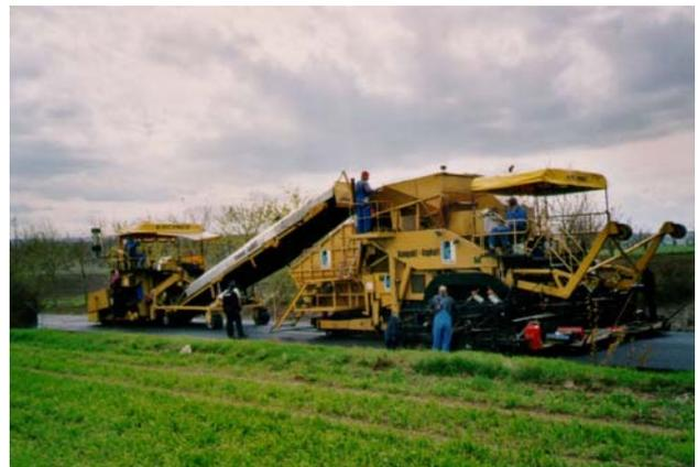
Abb. 3: Kompaktasphaltfertiger
