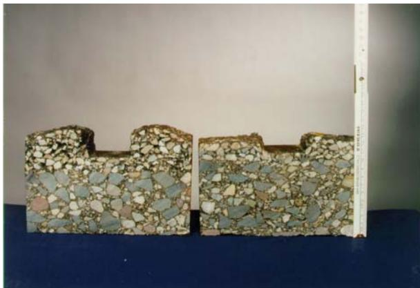
Abb. 2: Geringere Verformungsanfälligkeit des Kompaktasphaltes
