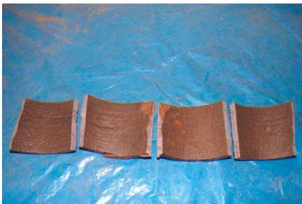
Abb. 2: Rohrstück nach Druckprobe
