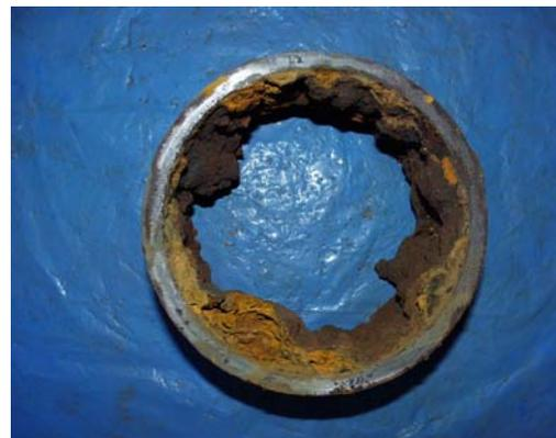
Abb. 3: Inkrustierte Rohrprobe
